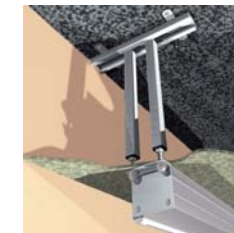
7 + 8 Deckenmontagesatz für Deckenmontage bei Zwischendecken bis 100 cm. Die Rohre können einfach abgelängt werden
