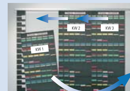
KW 1 ist abgelaufen. Tafel wird einfach nach vorne entnommen und rechts eingesetzt.
